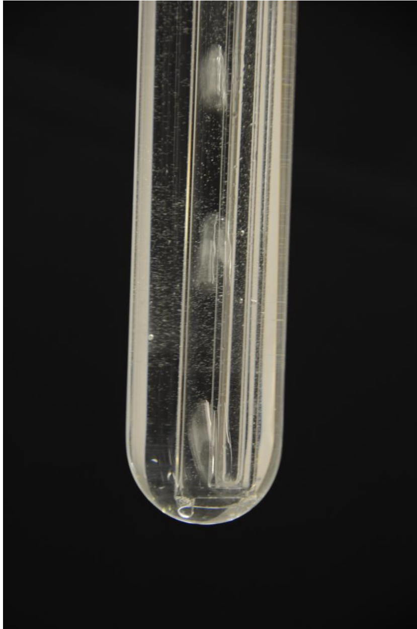
Abbildung 7.5: Im Betrieb steigen aus der Luftlanze Luftblasen auf, die im Mammutpumpeneinsatz nach oben geführt werden und dabei Flüssigkeit mit aufsteigen lassen. Drei Luftblasen sind hier in dem Mammutpumpeneinsatz zu erkennen. Für dieses Bild wurde das Anzuchtgefäß mit Wasser gefüllt.
