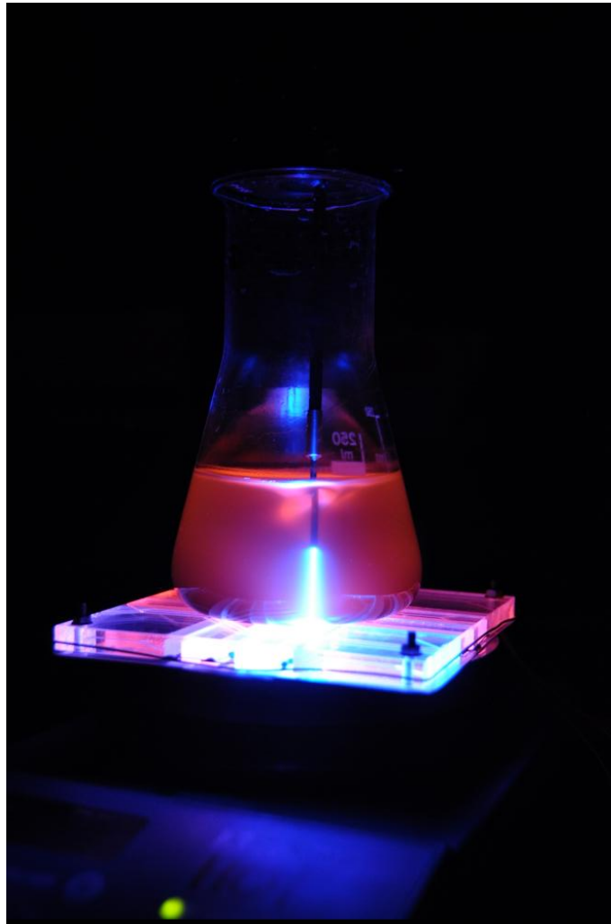
Abbildung 5.4: Eine gerührte Kultur von Dunaliella salina im Erlenmeyerkolben. Zwischen Magnetrührer und Glaskolben ist eine Plexiglasplatte zu sehen, in die acht Neonglimmlampen zur Wellenlängenkalibration eingelassen sind (vgl. Abb. 5.6). Von oben ragt das für die Ramanmessung verwendete Faserbündel in die Kultur, woraus ein blauer Laserstrahl in die Kultur scheint. Das rote Leuchten der Kultur ist in diesem Fall nicht die Chlorophyllfluoreszenz, sondern stammt von den unterhalb des Kolbens leuchtenden Neonglimmlampen. Die Lichtquelle für die Stressbeleuchtung (vgl. Abb. 5.8d) ist auf diesem Bild nicht vorhanden.
